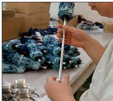
10. 手元の取付 Install handle
